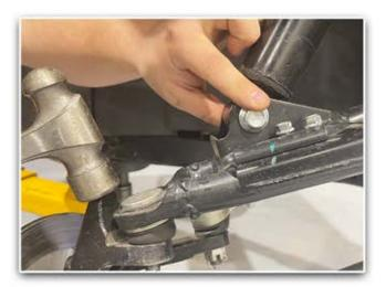
YOU CAN STRIKE THE KNUCKLE WITH A HAMMER TO LOOSEN THE UPPER ARM. ENSURE THE SHOCK BOLT IS STILL INSTALLED BEFORE YOU DO THIS.
