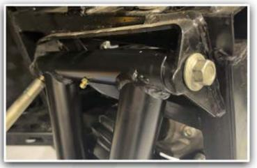
NEXT, INSTALL THE SHOCK ONTO THE SHOCK MOUNT ON THE ARM USING THE FACTORY HARDWARE. TORQUE TO FACTORY SPEC.
