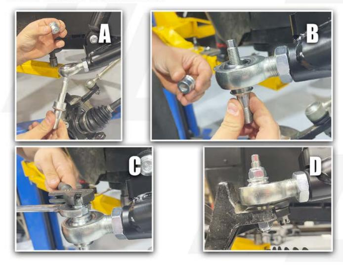
AT THIS PONT YOU NEED TO SWITCH OUT THE FACTORY TIE ROD END WITH THE PROVIDED EXTENDED ONE IN YOUR KIT. INSTALL USING THE FACTORY JAM NUTS. TORQUE TO FACTORY SPECS.
