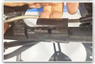
THE OTHER BRAKE LINE CLAMP CAN BE FLIPPED UP TO RELEASE THE BRAKE LINE.
