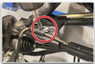
NEXT, YOU WILL NEED TO REMOVE THE TWO 10MM SCREWS FROM THE BRAKE LINE CLAMP.
