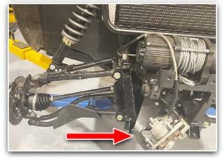
NOW YOU CAN MOVE THE BRAKE CALIPER TO THE SIDE.
