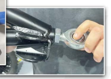
USING THE FACTORY HARDWARE, INSTALL THE UPPER ARM TO THE UTV. TORQUE TO FACTORY SPEC.
